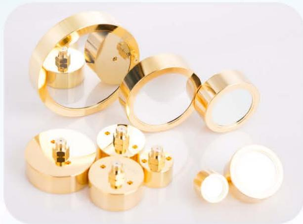
钝化离子注入平面硅探测器（PIPS）采用先进的半导体制程工艺制造，通过光刻技术精确确定几何外形，离子注入工艺精确控制掺杂深度分布，具有低漏电流和极薄死层厚度特性。平面硅探测器可用于  $\alpha$ 、 $\beta$  和质子等带电粒子探测。
